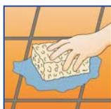
Sollten noch Reste von Fugenmörtel auf der Oberfläche sein, wischt man den Belag einmal mit Lithofin KF Sanitärreiniger, ca. 1:20 verdünnt. Danach nochmals mit klarem Wasser nachwischen, um die Verschmutzung von der Oberfläche zu entfernen.
